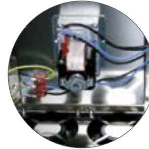
Ventilation des moteurs / Motors ventilation
